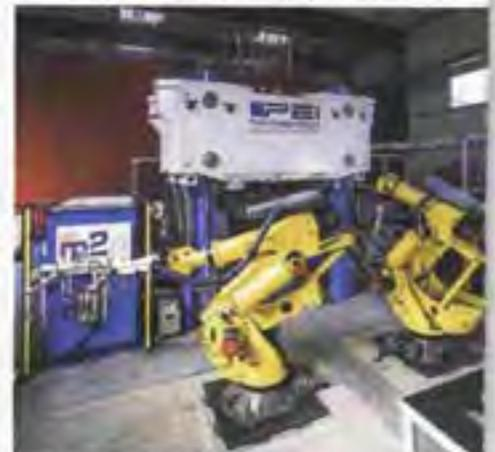
Con Fast RTM di IRT M2P sono sufficienti 120 secondi per produrre componenti strutturali con superficie fino a 3 metri quadrati, completamente rifiniti.
