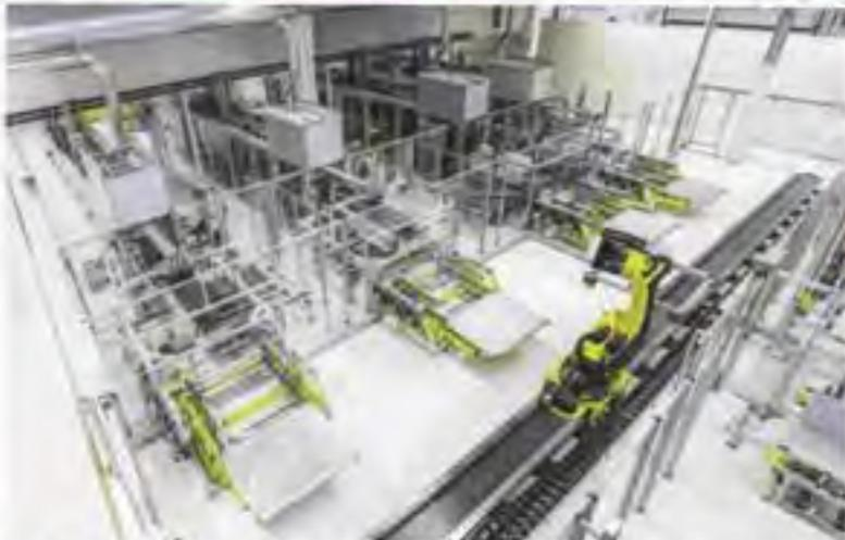
Voith Composites si è assicurata un posto tra i vicinati con Roving Applicator, attrezzatura automatizzata che parte da roving non trattati e legante in polvere per generare stack a secco.
