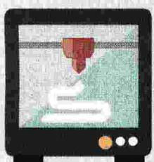
Deposita un filamento di plastica fusa sul supporto
